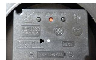
N a ontvangst van het tijdsignal DCF en de interne verwerking (5 tot 10 minuten), wordt de klok automatisch ingesteld op de tijd Nauwkeurige
